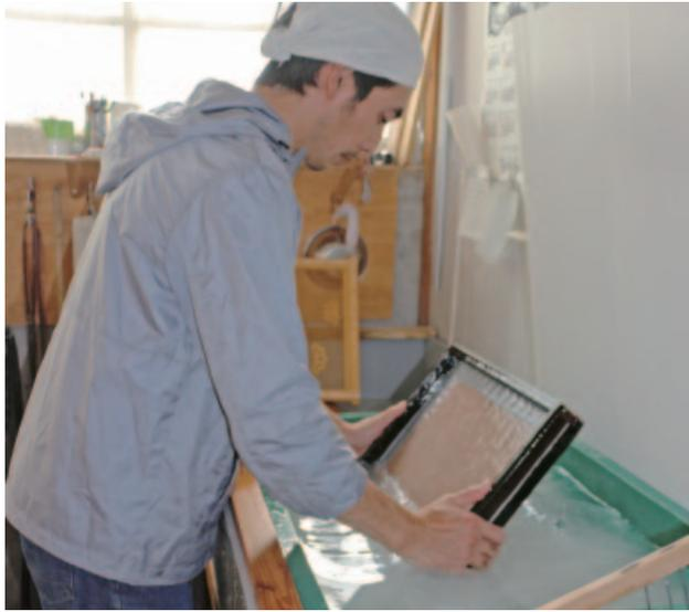
見返し紙に使った落水の技法—薄いベールのような楮(こうぞ)紙を漉き、濡れたままの状態を上から型紙をかざしてシャワーを強く掛けると、水の力に負けて紙に型通りの穴が空き、模様ができる。繊維の長さがぼかしのよう作用して、風合いゆたかな風情に仕上がった。(大豊和紙工業での作業風景)
